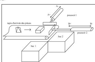
Remarques : On ne tiendra pas compte du fonctionnement du tapis pour les GRAFCET point de vue PO et PC. La vitesse du tapis est très largement inférieure à celle du vérin B. Il sera donc nécessaire de mettre une temporisation pour attendre que le colis soit tombé dans le bac 2 avant de remettre le poussoir 2 en position de repos.
